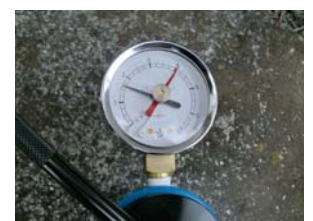
(スパイクの引き抜き試験) 躯体：シンダーコンクリート 計測結果：4000N ドリル径：φ4.8mm
