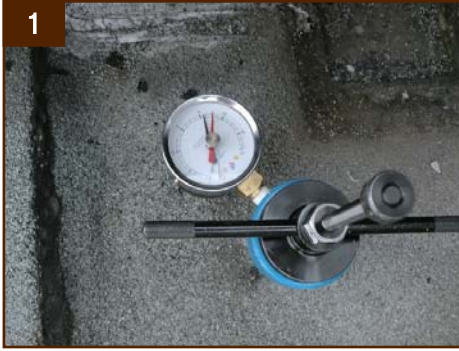
1 （引抜試験） 専用スパイクを最低 32mm 躯体に挿入し 3000N 程度の引抜強度が得られない場合はドリル径を下げます （標準ドリル径：φ 4.8mm）
