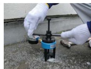
(スパイクの引き抜き試験) 躯体：シンダーコンクリート 計測結果：4000N ドリル径：φ4.8mm
