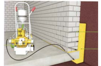
親水性 PU 樹脂は 2 液用ポンプで水と混合しながら土中に注入します
